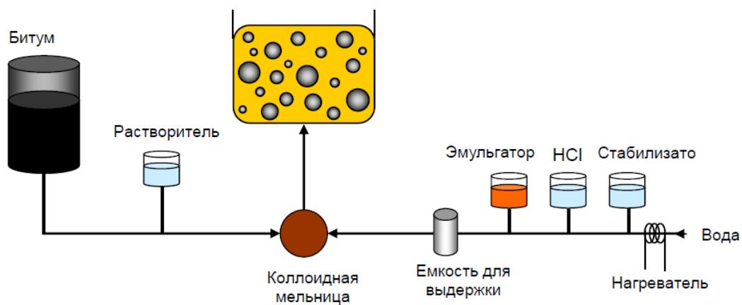
Битум и, если требуется, растворитель также непрерывно подаются в мельницу. В резервуаре с битумом поддерживается надлежащая температура. Установка непрерывного действия может работать до тех пор, пока имеется материал и пространство для хранения.
