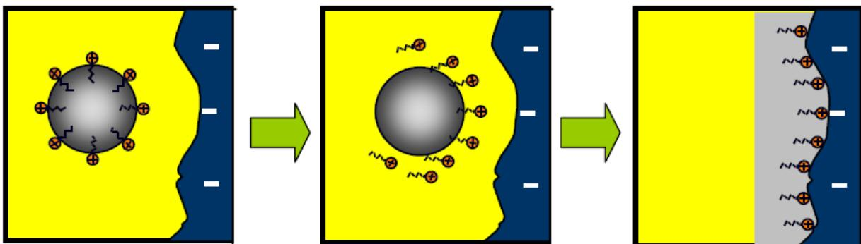
Распад можно контролировать путем выбора эмульгатора и содержания эмульгатора. Другими факторами, влияющими на распад, являются температура, влажность и тип битума.
