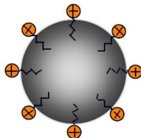
В катионной эмульсии положительно заряженные ионы ориентируются на поверхности битумных капель. Отрицательно заряженные ионы хлорида притягиваются к поверхности положительными зарядами, и в эмульсии формируется электрический двойной слой.
