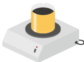
Погружаем в битум с добавкой, 165°C, 15 сек
