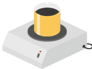
Погружаем в битум с добавкой, 165°C, 15сек
