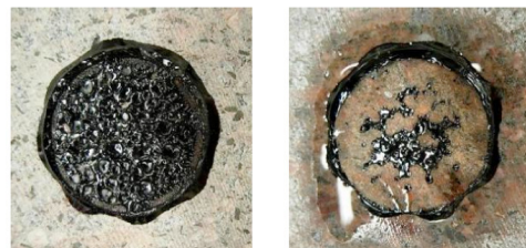
Рис. 2. Внешний вид испытанной поверхности после исследования по AASHTO TP 91 (когезионный и адгезионный отрыв) [8]
