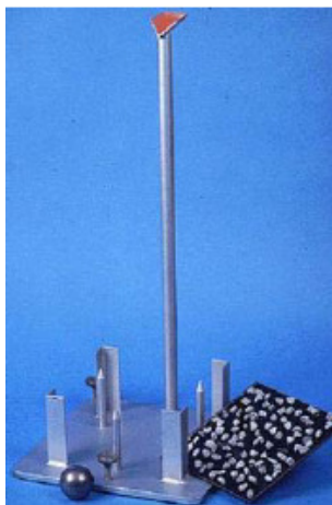
Рис. 4. Прибор для определения сцепления по Vialit Plate Test [10]
