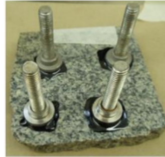
Рис. 1. Внешний вид отрывной заглушки, перед испытанием по AASHTO TP 91 [7]
